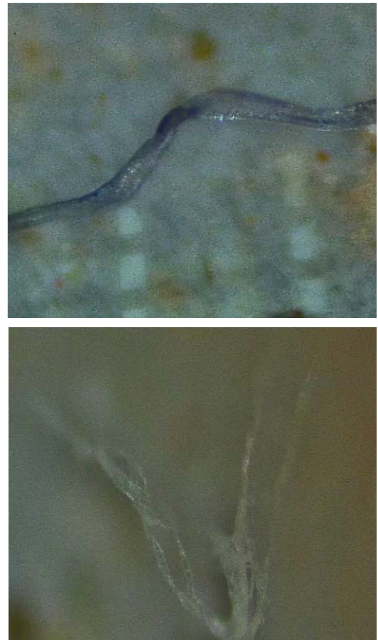
图5 条状纤维微塑料体视显微镜图
